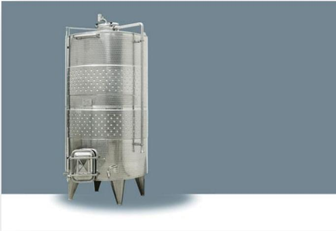
Contenitore in acciaio inox AISI 304/316 fiorettato con tetto conico, chiusino superiore Ø 300mm fino a lt 300 e Ø 400mm da lt 400. Predisposizione per il prelievo e scarico, asta segnalivello con protezione, disponibile nelle versioni: fondo piano; fondo inclinato su gambe; fondo conico su gambe; fermentino.
