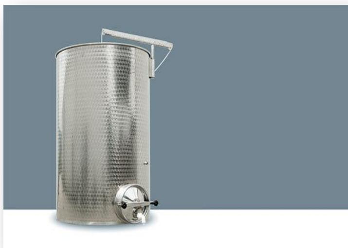
Serbatoio di stoccaggio cilindrico a sviluppo verticale con fondo piano e predisposizione per il prelievo. Realizzato in acciaio inossidabile 18/10 a finitura fiorettata, indicato per lo stoccaggio di olio, vino e miele. È disponibile in due versioni: UO uso oleario, completo di coperchio parapolvere; GOE con galleggiante ad olio enologico e coperchio; parapolvere; SP con galleggiante a sistema pneumatico.
