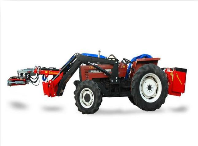
Il modello **AFP** è una macchina vibrante progettata per essere applicata su attacco pala caricatrice. Le operazioni di montaggio/smontaggio possono essere eseguite facilmente. Il modello AFP è stato disegnato per la raccolta di olive e mandorle e per soddisfare le esigenze di chi già possiede un trattore con pala. Caratteristiche generali: serbatoio olio e impianto idraulico montato posteriormente sull'attacco ai tre punti; alimentazione i-
