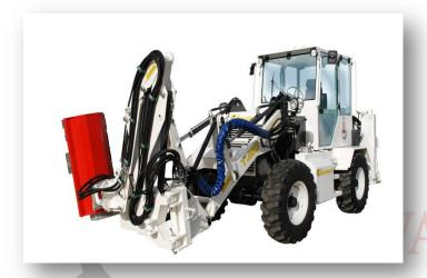
La **Pala Berardinucci** e' una macchina operatrice multifunzionale realizzata interamente nei nostri stabilimenti con le tecnologie piu' innovative. Essa dispone di: Benna di carico; retro escavatore; lama spalaneve; trincia e altri tipi di accessori. Optional: aria condizionata e riscaldamento.
