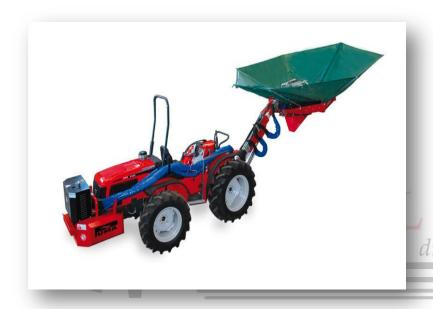
Il modello PUMA è una macchina vibrante semovente che utilizza una base trattrice A.Carraro TRG 9400 a guida reversibile. Questa macchina racchiude in sé potenza, dimensioni contenute ed ottima manovrabilità. Le quattro ruote motrici unitamente alla elevata stabilità rendono il PUMA particolarmente idoneo anche per l'impiego su terreni collinari con elevata pendenza.
