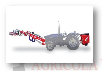
Il modello **TF** è una macchina vibrante progettata per il montaggio, tramite staffatura, sulla parte anteriore di trattrici agricole. Soddisfa pienamente le esigenze di coloro che prediligono questo tipo di applicazione ed ha le seguenti caratteristiche: applicazione braccio telescopico anteriore con testata vibrante; serbatoio olio e impianto idraulico montato posteriormente sull'attacco ai tre punti; alimentazio-
