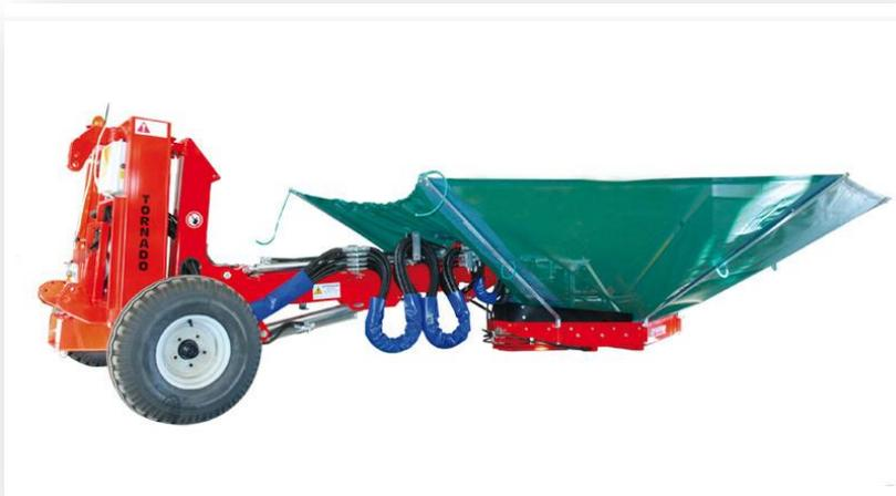
Il modello **TORNADO** è una macchina vibrante di nuova concezione con caratteristiche innovative. Progettata e realizzata specificatamente per la raccolta delle olive, la sua eccezionale versatilità di utilizzo la rende molto efficiente anche per la raccolta di pistacchi, mandorle, ciliegie e prugne. Il colle-
