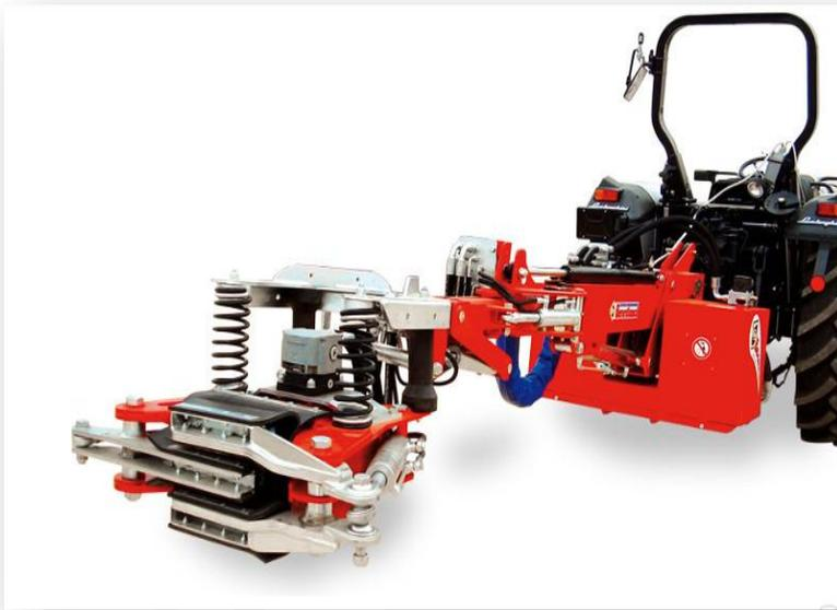
Il modello **UNIVERSAL** è una macchina vibrante progettata per l'applicazione su tutti i tipi di trattori con guida reversibile. Il collegamento al trattore avviene in modo molto semplice e rapido tramite l'attacco ai tre punti e giunto cardanico, senza ulteriori adattamenti meccanici. La struttura contenuta ed essenziale rendono la macchina estremamente pratica. Doppia sfilata del braccio telescopico che permet-
