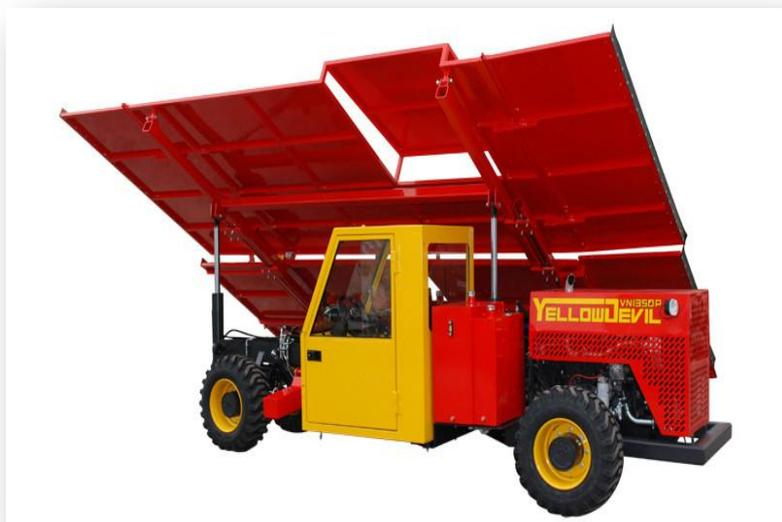
Il modello **YELLOW DEVIL** è una macchina vibrante semovente continuativa di ultima generazione. Questa macchina, realizzata interamente nei nostri stabilimenti, è stata disegnata e progettata appositamente per la raccolta meccanizzata continuativa in parallelo di olive, agrumi, prugne, mandorle e pistacchi su impianti intensivi e specializzati.
