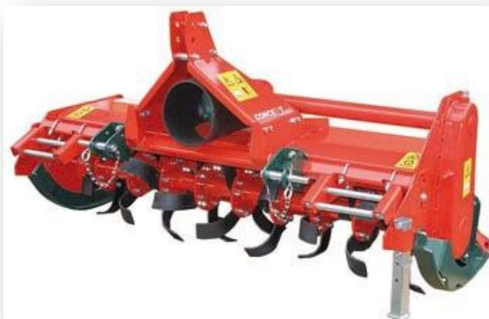
La fresa KF è la macchina ideale per lavorazioni professionali con trattori fino a 50HP in orti e a pieno campo. Slitte regolabili per ottenere la profondità di lavoro desiderata. Cofano posteriore regolabile per un livellamento ottimale del terreno. Robusta trasmissione laterale a catena di grande affidabilità.
