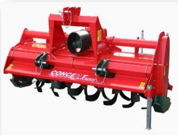
La robustezza della fresatrice GF la rende la macchina ideale per uso professionale con trattori fino a 95HP. Cofano posteriore regolabile per un livellamento ottimale del terreno. Robusto riduttore a 4 velocità per trattori fino a 95HP. Gli ingranaggi utilizzati nella robusta trasmissione laterale della fresa GF sono supportati da grossi cuscinetti di alta qualità per far fronte alle condizioni più gravose.
