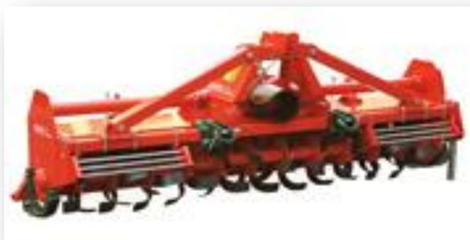
La HF è una macchina per grandi produzioni personalizzabile con vari tipi di rulli posteriori ed accessori. Il robusto riduttore a 4 velocità per trattori fino a 115HP e la trasmissione laterale ad ingranaggi garantiscono una grande affidabilità nelle condizioni più gravose.
