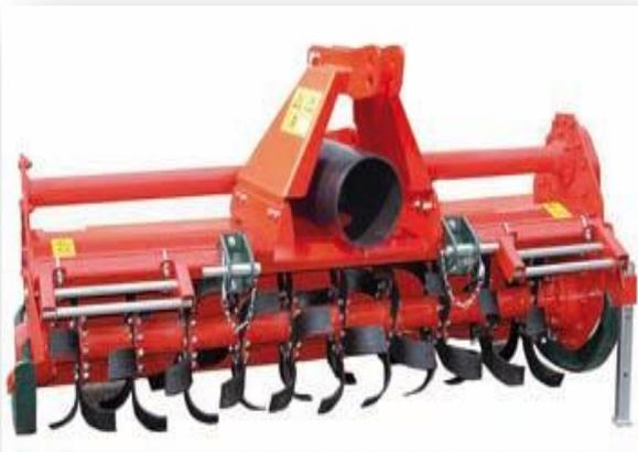
Il robusto riduttore in ghisa progettato per la UF è protetto da una frizione per evitare sovraccarichi. Cofano posteriore regolabile per un livellamento ottimale del terreno. Slitte regolabili per ottenere la profondità di lavoro desiderata. Gli ingranaggi da 35 mm di spessore utilizzati nella robusta trasmissione laterale della fresa UF sono supportati da grossi cuscinetti di alta qualità per far fronte alle condizioni più gravose.
