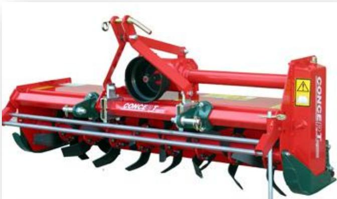
La fresa fissa XF ideale per trattori fino a 40HP, robusta trasmissione laterale a catena di grande affidabilità. Cofano posteriore regolabile per un livellamento ottimale del terreno. Slitte regolabili per ottenere la profondità di lavoro desiderata. Paraoli e cuscinetti riparati da una protezione labirinto.
