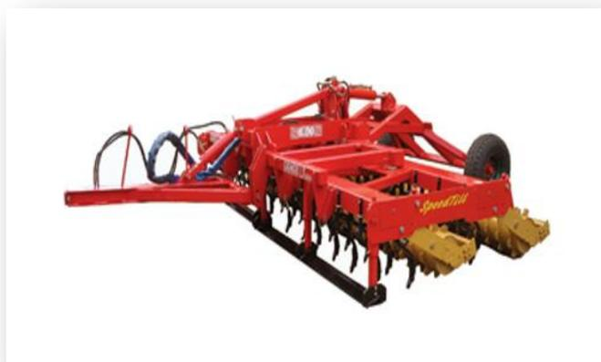
Speedtill è disponibile da 3 a 7m di larghezza lavorativa. I piccoli modelli (3, 3.5, 4 m) sono trattore e tutti possono essere dotati di un kit di trascinamento costituito da un timone di ruote anteriori e posteriori. Con i modelli da 3,5 a 4 m, il trasporto su strada è obbligatorio.
