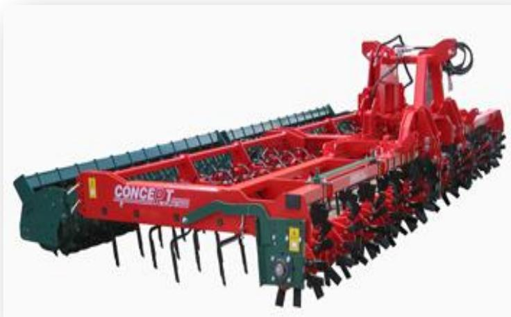
Il preparatore "Rotosprint" è costituito da un rullo che può essere usato in posizione flottante o rigida. Inoltre è caratterizzato da flange elicoidali per la massima lavorazione su tutta la larghezza, attacchi trattore flottanti, rotore regolabile su 4 posizioni e molle disposte su quattro file.
