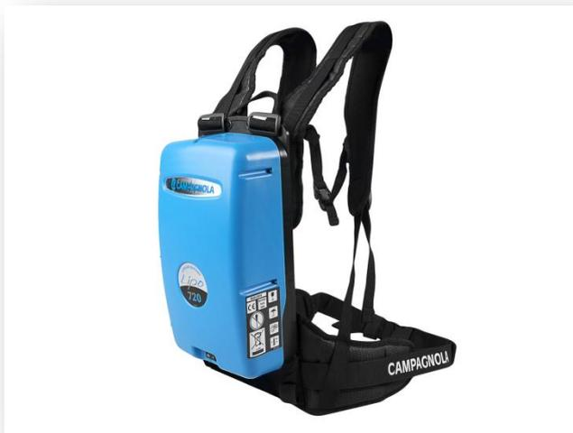
LIPO 720 è una batteria senza effetto memoria al litio/polimero ed è caratterizzata da una gestione elettronica, un dispositivo di sicurezza anti-avviamento accidentale ed un guscio in tecnopolimero ignifugo ed antiurto. La batteria è inserita in uno zaino ergonomico ed è utilizzabile per gli abbacchiatori elettrici ALICE ed HERCULES e per il potatore elettrico PUMA, ai quali garantisce una giornata di lavoro. La versione LIPO 550 è disponibile per i soli
