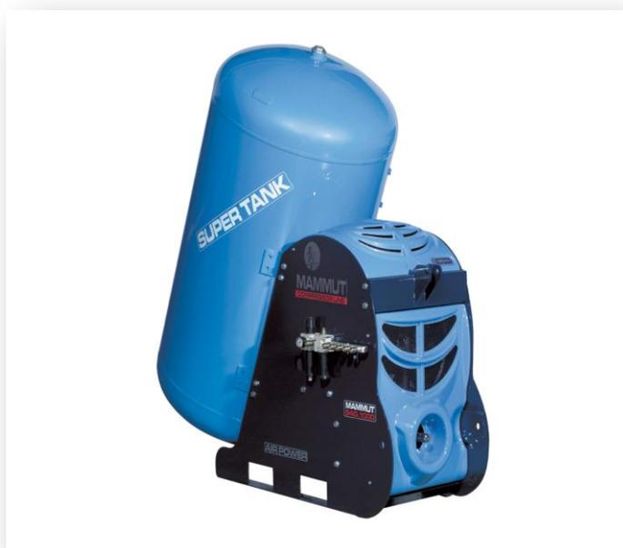
I compressori PTO MAMMUT 1000 e 1500 sono dotati di un grande serbatoio di aria compressa, che consente una prolungata autonomia di lavoro con il trattore spento. Questi compressori PTO sono dotati di potenti gruppi pompanti, con la piastra delle valvole in ghisa, e di una robusta cofanatura in ABS, che convoglia l'aria di raffreddamento sulla testata del compressore. Ciò evita il surriscaldamento dei componenti, garantendo una maggiore affidabilità e durata nel tempo.
