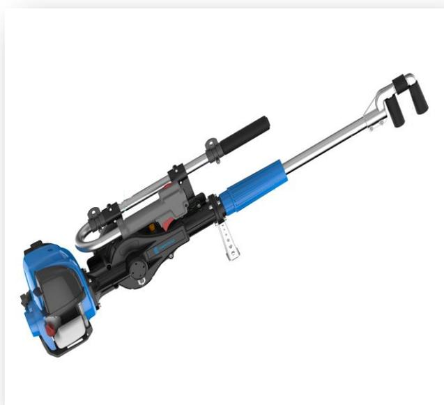
Il gancio scuotitore GSM EL TORO viene utilizzato per la raccolta di olive e frutta destinate all'industria. Dotato di un esclusivo supporto antivibrazioni (brevetto Campagnola) dell'impugnatura, un corpo in lega di alluminio e rulli di gomma girevoli, è azionato da un potente motore a 2 tempi da 52,5 cc che gli permette di scuotere rami di 50/60 mm di diametro. Il gancio scuotitore GSM EL TORO viene collegato ad un'asta di prolunga da 1,30 m, 2 m o 3,30 m.
