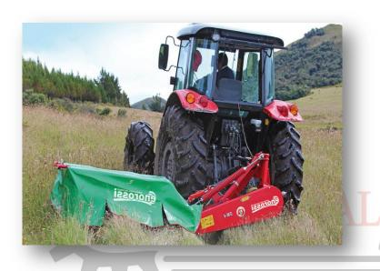
Falciatrice a dischi retroportata munita di sollevamento idraulico, sistema automatico di protezione per salvaguardare la barra da eventuali ostacoli, completa di albero cardanico a ruota libera, telo di protezione, disco per andana e sgancio automatico di sicurezza. Barra di taglio ENOCUT in acciaio della migliore qualità costruita da Enorossi.
