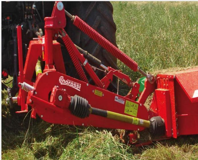
Falciatrice a dischi retroportata munita di sollevamento idraulico, sistema automatico di protezione per proteggere la barra da eventuali ostacoli, completa di albero cardanico a ruota libera, telo di protezione, disco per andata e sgancio automatico di sicurezza. La barra di taglio ENOCUT in acciaio della migliore qualità, viene lavorata con precisione internamente da Enorossi. Completa di condizionatore a rulli ROLL.
