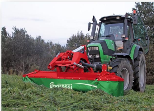
Falciatrice con attacco corto munita di un efficace sistema di compensazione per ottimizzare l'adattamento al terreno, completa di dischi formandana. Compensazione a molle pratica e semplice: due robuste molle di compensazione garantiscono una pressione uniforme sul terreno per tutta la larghezza della barra falciante. Questa pressione ottimale sul terreno è regolabile in modo rapido.
