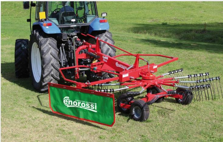
Giroandatore disponibile nelle versioni retroportata o trainata a seconda delle necessità del cliente. Dotato di 4 ruote pneumatiche tandem che garantiscono un rastrellamento perfetto e del foraggio pulito anche su terreni ondulati ed irregolari. Gli assali Tandem dispongono di una notevole distanza tra le ruote, che contribuisce ad un'ottima stabilità del ran-
