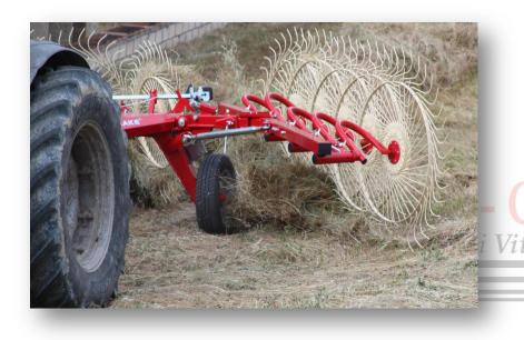
**BATRAKE** nasce con l'obiettivo di essere una macchina robusta e con alte prestazioni. Ogni braccio ha il movimento indipendente, notevole vantaggio l'adattamento al terreno e per ottenere un'ottima formazione dell'andana con la massima pulizia del terreno. Il sistema EASYJOB® con cilindri idraulici a semplice
