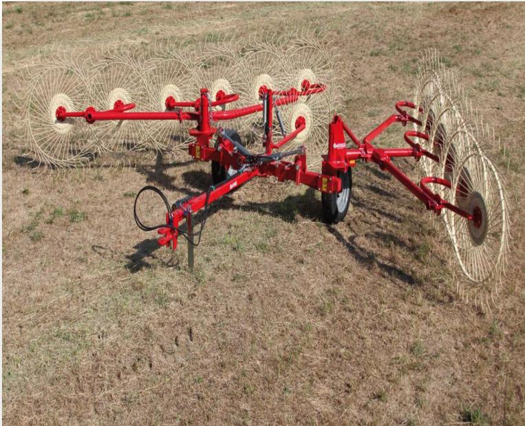
La scelta economica per i ranghinatori stellari trainati a V. Lavoro di rastrellamento pulito anche su terreno accidentato. Dispositivo idraulico per passare dalla posizione di trasporto alla posizione di lavoro e viceversa. La larghezza di lavoro è regolabile con un selettore manuale. A richiesta disponibile kit per lavorare da un solo lato, possibilità di avere una stella centrale per muovere il prodotto.
