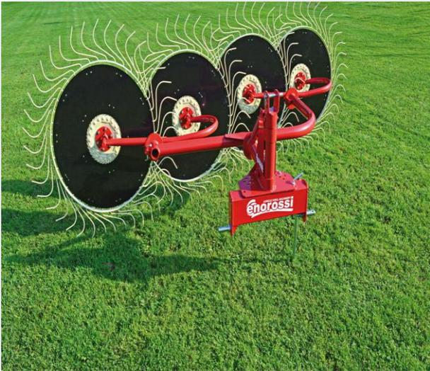
Ranghinatore estremamente semplice ed efficace, ideale per qualsiasi tipo di foraggio. Il sistema di molleggio del portattrezzi permette alle stelle di adattarsi a qualsiasi tipo di terreno con la giusta pressione senza intaccare la qualità del foraggio. Stelle indipendenti ed intercambiabili montate su mozzi con cuscinetti a rulli conici. Denti in acciaio flessibile  $\varnothing$  6,9 mm. RP 2C/3C con attacco per piccoli trattori. BS: braccio telaio sdoppiato. RP5/RP 6 no trasporto stradale.
