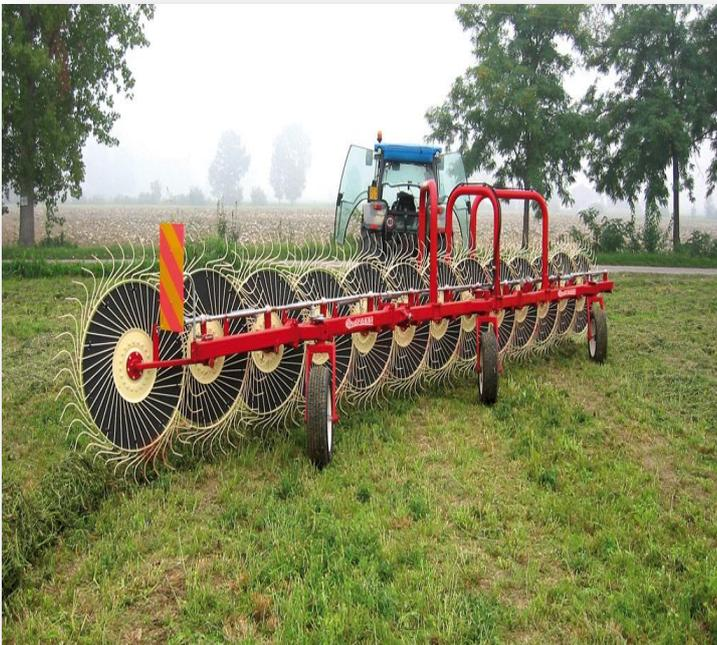
Ranghinatore Stellare in linea dotato di 3 ruote, quattro ruote nel modello RT 13 HFLEX . La larghezza di lavoro è regolabile idraulicamente nel modello RT 13HFLEX e con un selettore per i modelli RT 7 e 9. Passaggio dalla posizione di trasporto a quella di lavoro e viceversa, direttamente dalla cabina del trattore. Sollevamento idraulico delle ruote stellari. Ruote stellari 145 cm., n ° 40 denti , filo Ø 6,9 mm. con flangia centrale da 3,5 mm di spessore.
