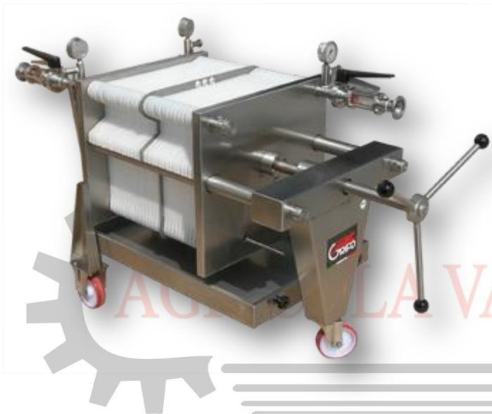
I filtri a piastre sono costruiti in acciaio inox od acciaio smaltato e dotati di piastre in nylon lineare tra le quali vanno inserite gli strati filtranti. Sono stati studiati per poter sgrossare, brillantare e sterilizzare, usando gli strati filtranti adatti, vini, olii, aceti, liquori, essenze naturali, prodotti per l'erboristeria e prodotti per la cosmesi. La nostra proposta è ampia, si va dai piccoli filtri per uso domestico, comunque robusti ed affidabili, chiamati
