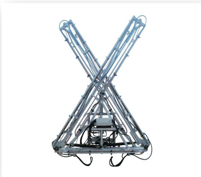
Barra da diserbo a 2 pistoni idraulici a chiusura posteriore a X con regolatori di velocità per l'apertura e la chiusura; Centralina di comando elettroidraulica per i 5 movimenti della barra; Livellante idraulico; Bloccaggio e sollevamento idraulico; Valvole di blocco idrauliche; Telaio in acciaio zincato a freddo; Tubi portagetti in acciaio inox filettati 1/2" con fori a distanza 500 mm; Snodo di sicurezza sul primo braccio; Morsetti fermatubo; Senza getti e ugelli.
