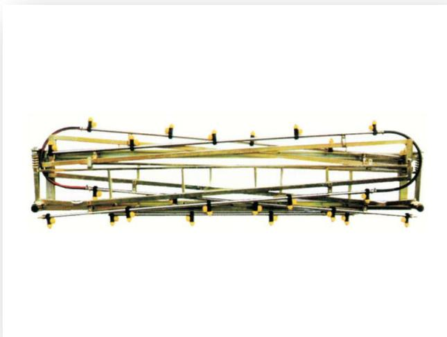
Barra manuale a chiusura posteriore a libro; Telaio in acciaio zincato a freddo; Tubi portagetti in acciaio inox filettati 1/2" con fori a distanza 500 mm; Snodo di sicurezza sul primo braccio; Morsetti fermatubo.
