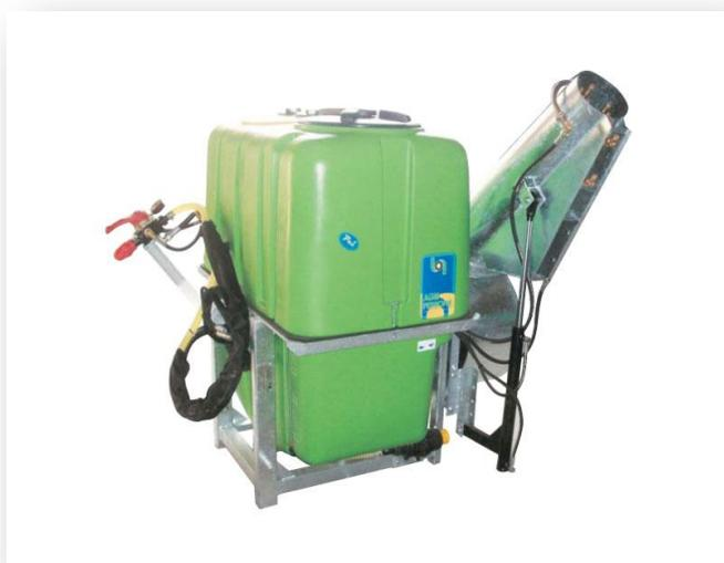
Serbatoio in polietilene; Serbatoio lavamani; Indicatore di livello esterno; Telaio zincato a caldo getti in ottone; Filtro aspirazione esterno con auto riempimento; Moltiplicatore ad ingranaggi; Convogliatore con ventola zincato; Doppia girante centrifuga con frizione orientabile manualmente; Distributore regolatore di pressione a distanza; Agitatore idraulico e senza giunto cardanico.
