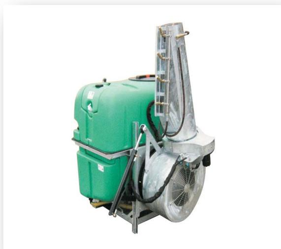
Serbatoio in polietilene; Serbatoio lavamani; Serbatoio lava circuito; Indicatore di livello esterno; Telaio zincato a caldo e getti antigoccia in ottone; Filtro aspirazione esterno con auto riempimento; Moltiplicatore ad ingranaggi; Convogliatore con ventola zincato; Doppia girante centrifuga con frizione orientabile idraulicamente; Rotazione canna idraulica 270°; Distributore regolatore di pressione a distanza; Agitatore idraulico e senza giunto cardanico.
