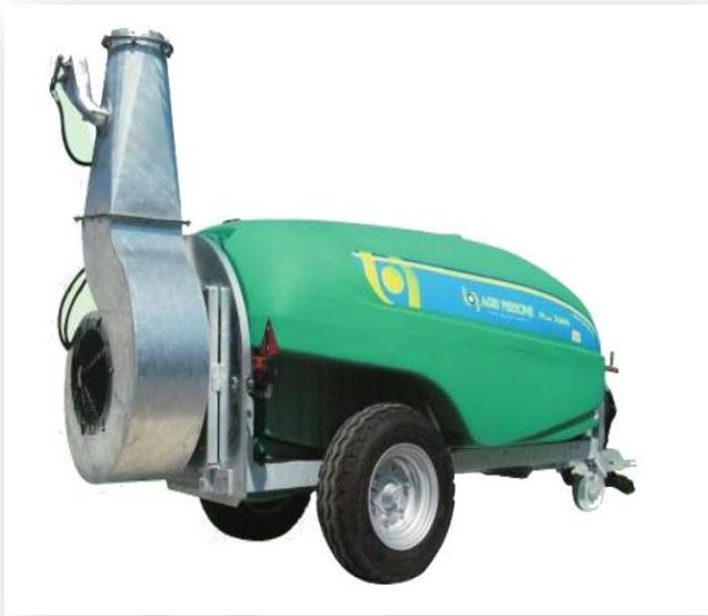
Serbatoio in polietilene; Serbatoio lavamani; Serbatoio lava circuito; Indicatore di livello esterno; Telaio zincato a caldo; Piedino con ruota; Getti antigoccia in ottone; Filtro aspirazione esterno con auto riempimento; Moltiplicatore ad ingranaggi; Convogliatore con ventola zincato; Doppia girante centrifuga con frizione; Rotazione canna idraulica 180°; Distributore regolatore di pressione a distanza; Agitatore idraulico e senza giunto cardanico.
