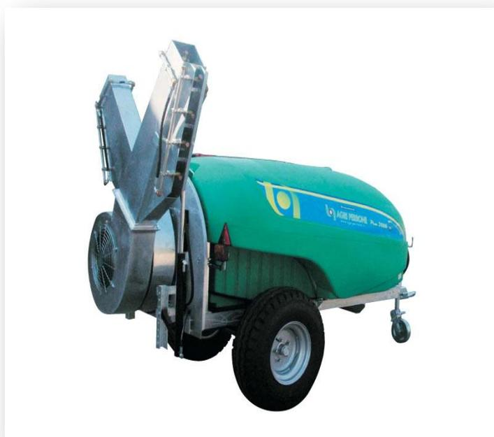
Serbatoio in polietilene; Serbatoio lavamani; Serbatoio lava circuito; Indicatore di livello esterno; Telaio zincato a caldo; Piedino con ruota; Getti antigoccia in ottone; Filtro aspirazione esterno con auto riempimento; Moltiplicatore ad ingranaggi; Convolgiatore con ventola zincato; Doppio cannone con doppia girante centrifuga con frizione orientabile idraulicamente; Distributore regolatore di pressione a distanza; Agitatore idraulico e senza giunto cardanico.
