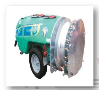
Serbatoio in polietilene; Serbatoio lavamani; Serbatoio lava circuito; Indicatore di livello esterno; Telaio zincato a caldo; Piedino con ruota; Getti doppi antigoccia in ottone; Filtro aspirazione esterno con auto riempimento; Due filtri autopulenti sulla mandata; Moltiplicatore ad ingranaggi; Convogliatore con ventola zincato; Elica brevettata a passo variabile con frizione; Raddrizzatore d'aria; Distributore regolatore di pressione a distanza; Agitatore idraulico e senza giunto cardanico.
