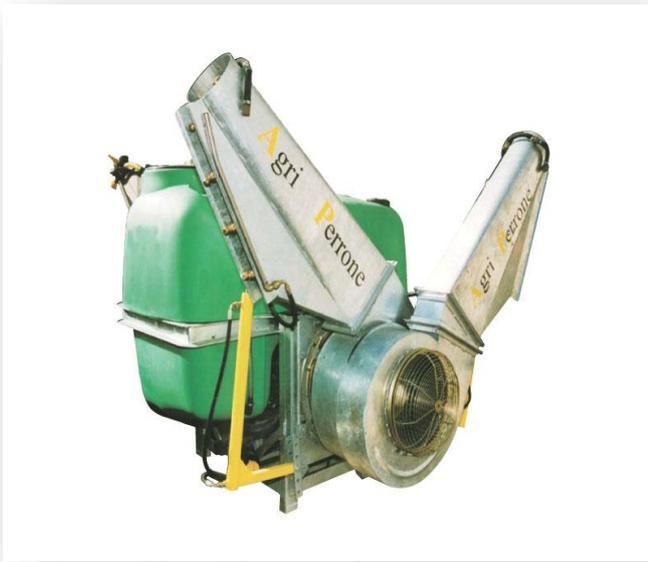
Serbatoio in polietilene; Serbatoio lavamani; Serbatoio lava circuiti; Indicatore di livello esterno; Telaio zincato a caldo; Getti doppi antigoccia in ottone; Filtro aspirazione esterno con auto riempimento; Moltiplicatore ad ingranaggi; Convogliatore con ventola zincato; Doppia girante centrifuga con frizione e doppio cannone orientabile idraulicamente; Distributore regolatore di pressione a distanza sul telaio; Agitatore idraulico e senza giunto cardanico.
