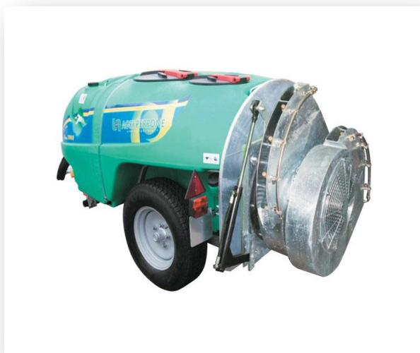
Serbatoio in polietilene; Serbatoio lavamani; Serbatoio lava circuito; Indicatore di livello esterno; Telaio zincato a caldo; Getti in ottone; Filtro aspirazione esterno con auto riempimento; Moltiplicatore ad ingranaggi; Convogliatore con ventola zincato; Doppia girante centrifuga con frizione e doppia chicciola orientabile manualmente; Distributore regolatore di pressione a distanza; Agitatore idraulico senza giunto cardanico.
