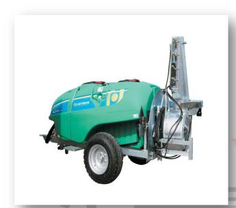
Serbatoio in polietilene; Serbatoio lavamani; Serbatoio lava circuito; Indicatore di livello esterno; Telaio zincato a caldo; Piedino con ruota; Getto in ottone; Filtro aspirazione esterno con auto riempimento; Moltiplicatore ad ingranaggi; Convogliatore con ventola zincato; Doppia girante centrifuga con frizione orientabile manualmente; Distributore regolatore di pressione a distanza; Agitatore idraulico e senza giunto cardanico.
