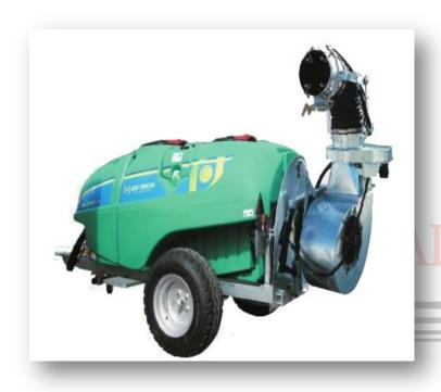
Serbatoio in polietilene; Serbatoio lavamani; Serbatoio lava circuito; Indicatore di livello esterno; Telaio zincato a caldo; Getti antigoccia in ottone; Filtro aspirazione esterno con auto riempimento; Moltiplicatore ad ingranaggi; Convogliatore con ventola zincato; Doppia girante centrifuga con frizione; Testata orientabile e inclinabile idraulicamente; Distributore regolatore di pressione a distanza; Agitatore idraulico e senza giunto cardanico.
