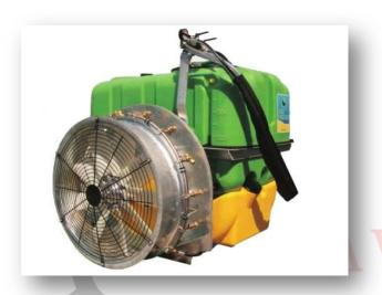
Serbatoio in polietilene; Serbatoio lavamani; Serbatoio lava circuiti; Indicatore di livello esterno; Telaio zincato a caldo; Getti doppi antigoccia in ottone; Filtro aspirazione esterno con auto riempimento; Moltiplicatore ad ingranaggi; Convogliatore con ventola zincato; Elica brevettata; Distributore regolatore di pressione a distanza sul telaio; Agitatore idraulico e senza giunto cardanico.
