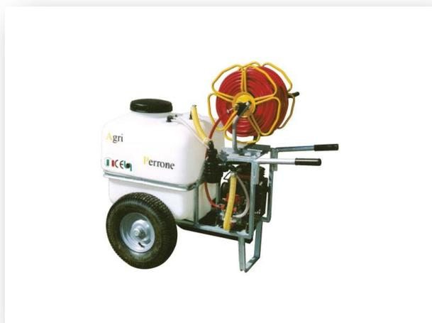
Serbatoio in polietilene; Indicatore di livello esterno; Telaio zincato a caldo; Filtro aspirazione esterno con auto riempimento; Distributore regolatore di pressione a distanza; Lancia a leva; Metri 50 tubo Ø8; 25 bar; Motopompa a scoppio o elettrica, con pompa da 25 lt al minuto.
