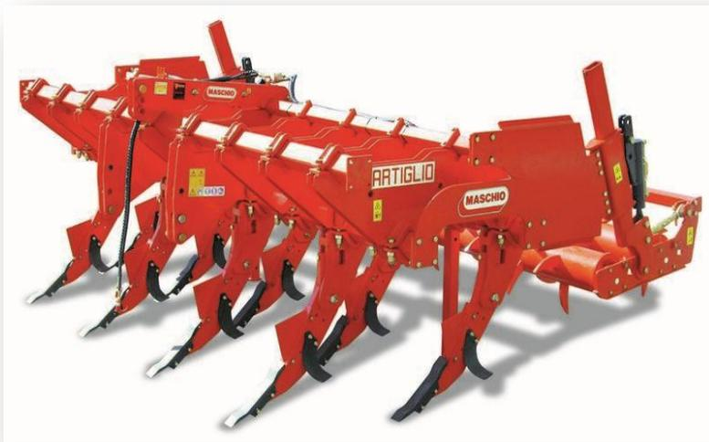
Il modello **ARTIGLIO IDRO-PNEUMATICO** è ideale per trattori di elevata potenza (tra 150 e 350 HP). La profondità di lavoro massima è di 55 cm e sono disponibili versioni di diversa larghezza, con soluzioni da 5 a 9 ancore. Il sistema di sicurezza idropneumatico con accumulatore di azoto garantisce la protezione della
