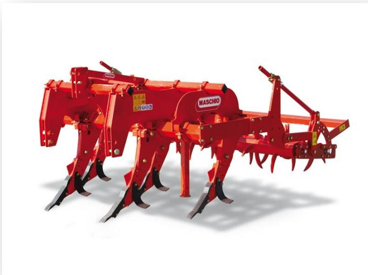
Il modello **PINOCCHIO** è indicato per trattori di ridotta o media potenza (tra 50 e 160 HP), si distingue per una profondità di lavoro massima di 45 cm ed è disponibile in diverse larghezze con soluzioni da 3 a 7 ancore, ideali per piccole e medie Aziende. Le ancore sono dotate di un sistema di sicurezza a bullone di trancio, mentre il doppio rullo posteriore può essere regolato manualmente tramite perni.
