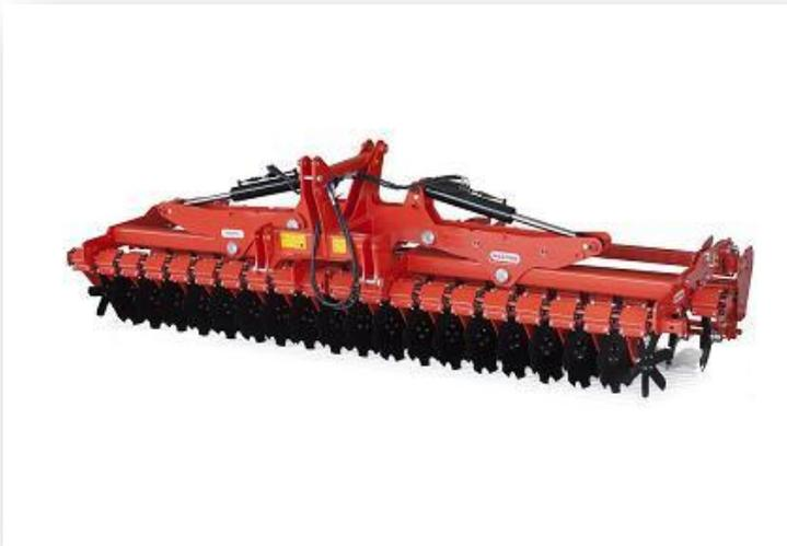
**PRESTO** è una dischiera leggera per lavorazioni superficiali del letto di semina (fino a 10 cm). I dischi sono disposti su due ranghi a orientamento contrapposto; l'ampia spaziatura (620 mm) riduce al minimo ogni possibile intasamento di terreno e residui colturali. Ogni disco ha un suo mozzo indipendente con cuscinetto sigillato in bagno d'olio; questo garantisce la massima resistenza e
