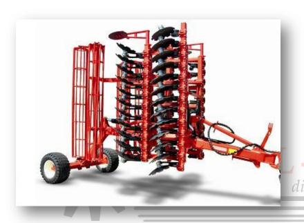
**UFO** a telaio pieghevole è una macchina ad elevate dimensioni e prestazioni per lavorazioni a dischi su grandi estensioni: la scelta vincente per aziende di grandi dimensioni in cui i tempi per la preparazione dei terreni sono molto ridotti . I trattori da abbinare a UFO pieghevole sono di grandi dimensioni, per un range da 160 a 360 hP.
