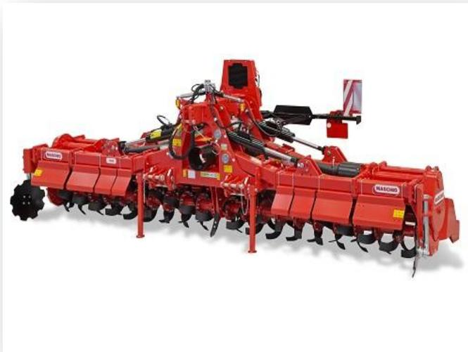
La fresa baulatrice pieghevole **JANE** risponde alle esigenze di contoterzisti e grandi aziende agricole. La rigidità della struttura e la qualità dei materiali impiegati garantiscono elevati standard di affidabilità e produttività, coniugati a un agevole e sicuro trasporto su strada. Sono disponibili 5 diverse larghezze di lavoro (420, 470, 520, 570, 620 cm), per abbinamenti a trattori da 200 a 380 HP.
