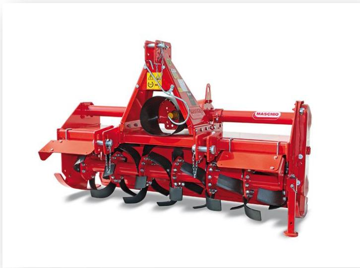
Il mod. U, adatto per trattori di media potenza, è una delle più collaudate ed affidabili. Questo modello mantiene alcune caratteristiche comuni proprie del successo delle zappatrici Maschio: trasmissione laterale ad ingranaggi, particolare robustezza del telaio e della scatola di trasmissione con possibilità di cambio a 4 velocità di progettazione Maschio.
