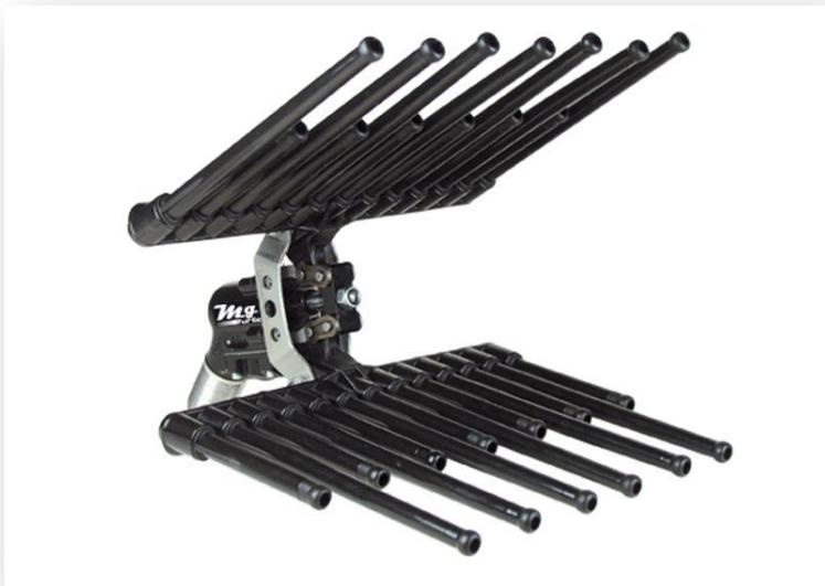
L'abbacchiatore Mg Turbo è dotato di un corpo pistone comodo e di piccole dimensioni. Le astine intercalate raccolgono anche le olive più difficili da raggiungere. Mg Turbo è un abbacchiatore pneumatico leggero e maneggevole, realizzato in titanio e magnesio. È molto comodo da utilizzare perché il corpo del pistone è di piccole dimensioni. Potente nella raccolta delle
