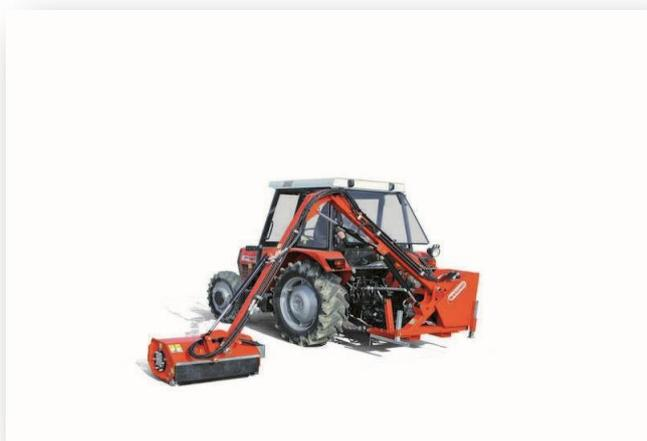
MARGHERITA è un braccio decespugliatore per l'utilizzo in agricoltura. Adatto allo sfalcio d'erba e arbusti in argini e fossati limitrofi agli appezzamenti. La compattezza del braccio permette lo sfalcio a filo ruota senza l'ingombro della carreggiata opposta. Già dotata di s40erie di pompa e motore ad alto rendimento in ghisa.
