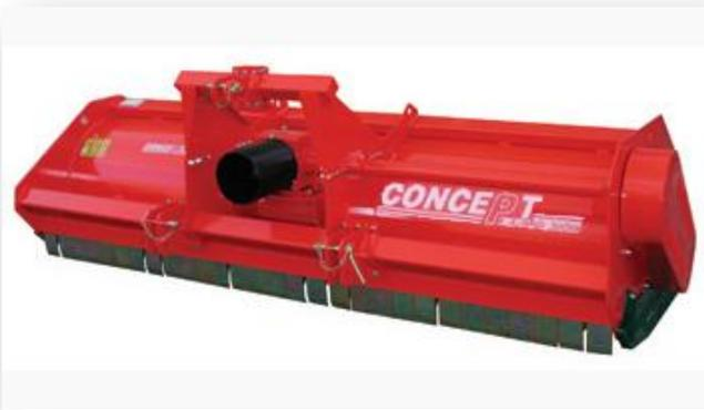
Rullo posteriore con estremità di forma sferica per la regolazione dell'altezza di taglio. Cinghie della migliore qualità per la massima affidabilità della trasmissione laterale. Robusto rotore di grande diametro e ruote posteriori pivotanti a richiesta.
